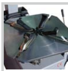
Spannteller Turntable Disque de montage
